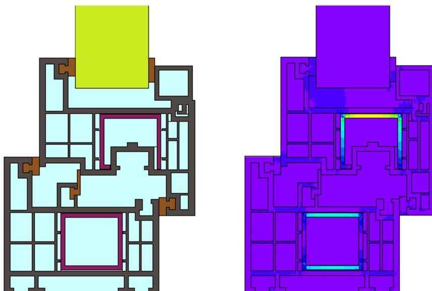
**Bild 2.3-2** Konstruktion des Kunststoffrahmens gemäß DIN 4108 Bbl. 2:2019-06 und farbige Darstellung der Wärmestromdichte
